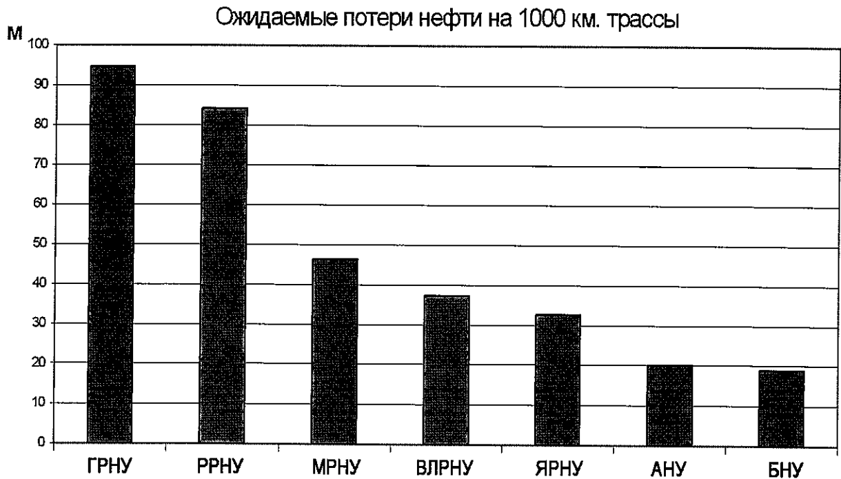
Рисунок 8-4. Ранжирование ОПО по удельным материальным потерям нефти
