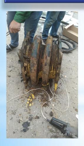
Авария произошла 08.08.2022 на опасном производственном объекте III класса опасности «Сеть газоснабжения г. Астрахани» организации АО «Астраханьгазсервис» по адресу: г. Астрахань, Трусовский район, ул. Площадь Заводская, 41а в результате утечки газа в линзовом компенсаторе, установленном в газовом колодце.
