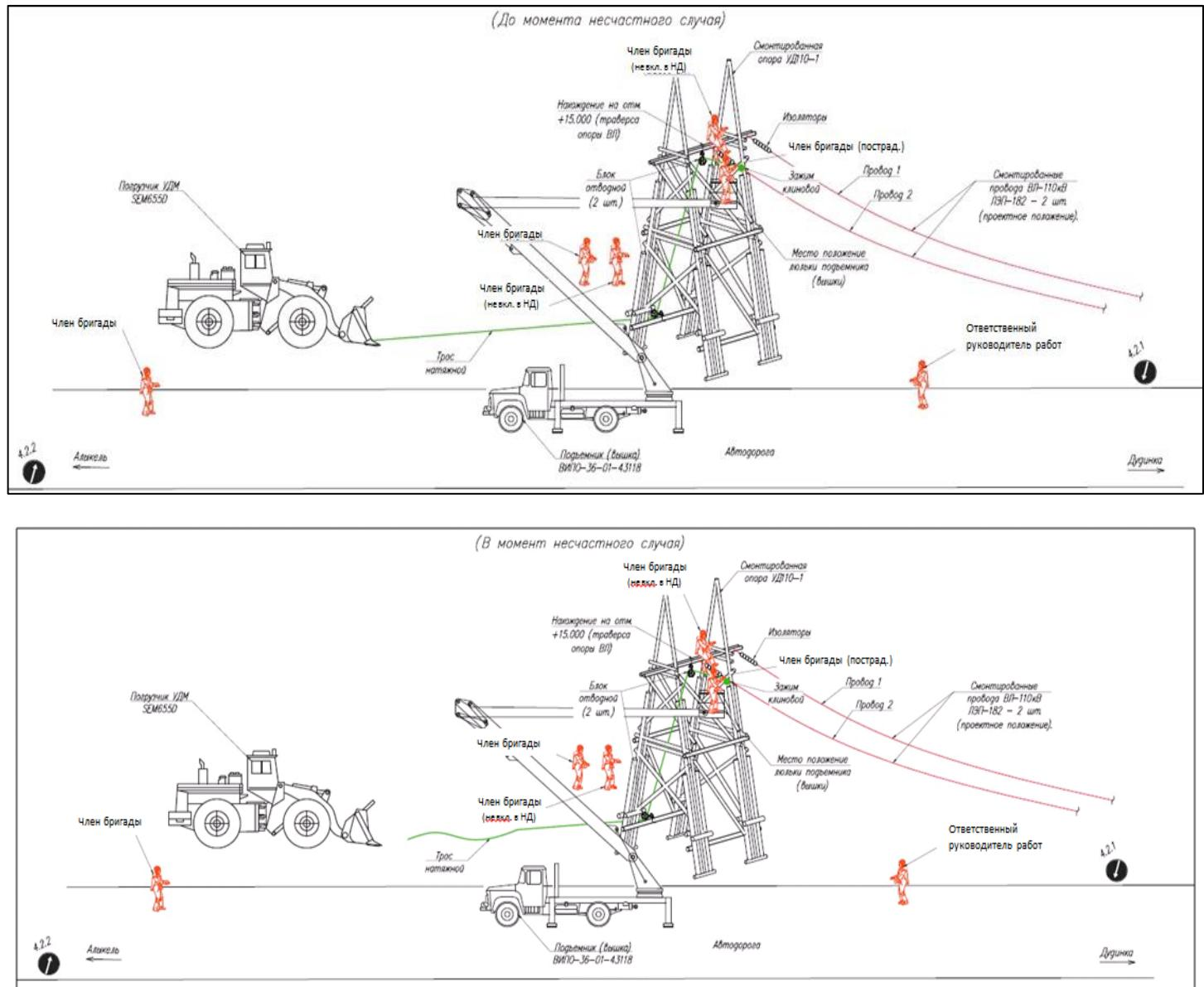
Производитель работ и электромонтеры-линейщики с люльки автогидроподъёмника произвели разрезку трёх проводов ВЛ-110 кВ ЛЭП-182 в пролёте опор № 199-200 на расстоянии 100 метров от опоры № 199. Далее был проведён монтаж проводов ВЛ-110 кВ ЛЭП-182 со стороны опоры № 200 на деревянную опору УД-110-1. Трое членов бригады соединяли и удлиняли провода, отходящие от опоры № 199 и лежащие на земле. После был выполнен монтаж первого провода (фаза 1) на деревянную опору УД-110-1.
